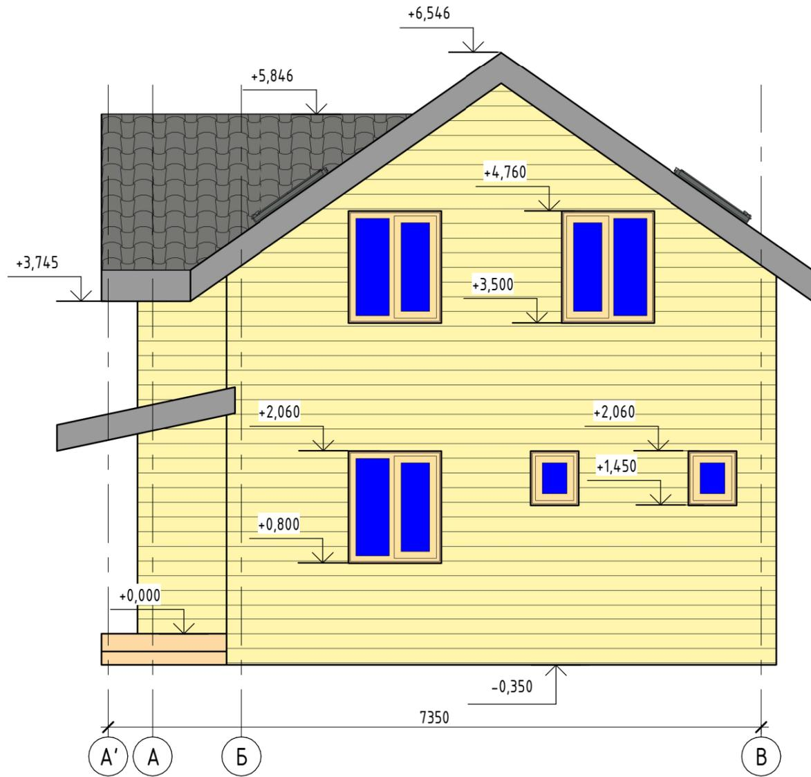
Фасад в осях В-А'
